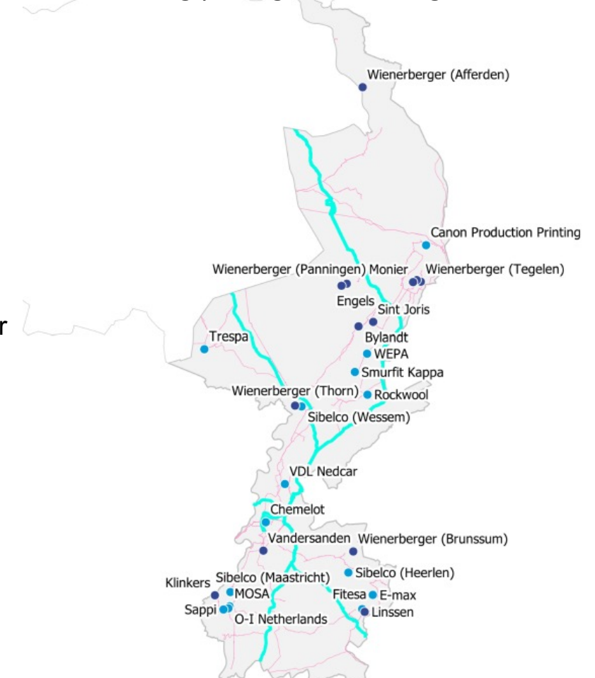
Figuur: Mogelijke tracés voor de waterstofbackbone in Limburg (blauwgroen; andere gasbuizen in roze)
